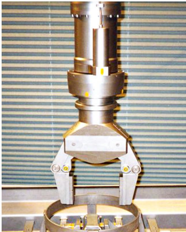
**Le BRAS UNIVERSEL est un moyen de préhension à distance se déplaçant suivant un axe vertical, utilisable dans toute cellule équipée d'une unité de levage, pour des interventions lourdes et destiné à la manipulation d'éléments métalliques ou non, irradiants ou contaminés.**
