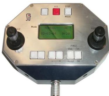
Le pilotage électronique permet l'utilisation d'un *mode plan* : l'utilisateur choisit alors de déplacer l'extrémité du bras uniquement dans un plan horizontal et vertical. Cette fonctionnalité permet par exemple de se déplacer en restant toujours à égale distance d'une paroi, ce qui est très utile pour son nettoyage.
