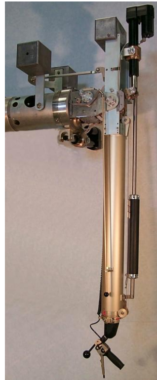
BRAS MAITRE AVEC EQUILIBRAGE SIMPLE ET GENOUILLERE FIXE
