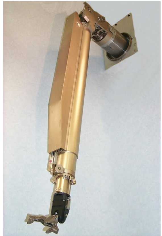
BRAS ESCLAVE AVEC GENOUILLERE DECONNECTABLE ET PINCE TITANE A BECS FIXES.
